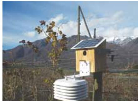
Ein Mikrocomputer in diesem Vogelhaus steuert die Sensoren und leitet die Information an die Software weiter.
